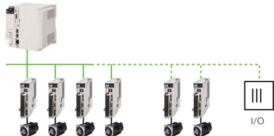
CPU-301/302 (16 axes)：最大 21 站 (伺服最大 16 軸)
